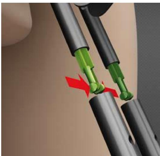
Вот эти фиксаторы отвечают за положение штанг. Когда проведете все манипуляции с длиной штанг, убедитесь в том, что штанги надежно зафиксированы. Затем, при выборе силы растяжения, они снова будут принимать участие в процессе, но об этом ниже.
